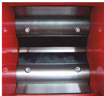
Mezera mezi ostřím štěpkovacích nožů je max 0,1 mm. Štěpkovač proto přeseke i tenké větvičky.
